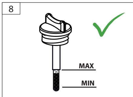
**DE Aus Gründen der Qualitätssicherung wird jedes Gerät einem Probelauf unterzogen und mit Motorenöl gefüllt. Vor dem Transport wird das Öl wieder abgelassen, es können sich jedoch Rückstände von Motorenöl am Messstab befinden. Bitte trotzdem Ölstand gewissenhaft überprüfen und Motorenöl nachfüllen.**
