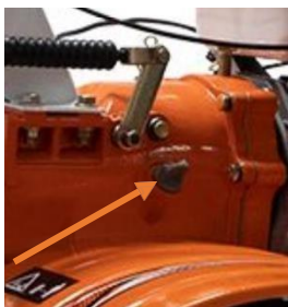
Obr. 5 - Kontrola hladiny prevodového oleja
