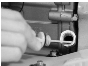
Obr. 5 - Kontrola hladiny motorového oleja
