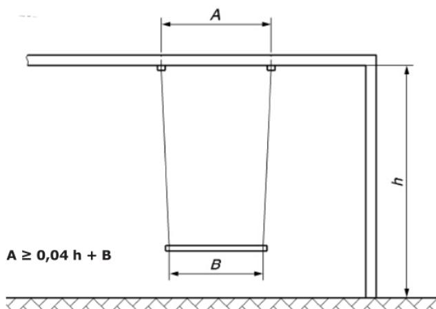
A - Vzdálenost mezi body zavěšení podél nosníku.
