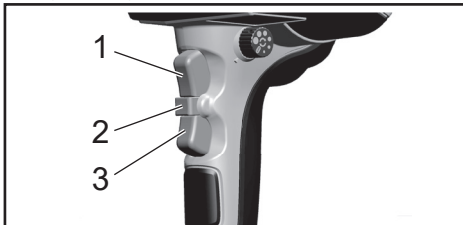
► 1. Прекидач рада унапред 2. Бравица прекидача 3. Прекидач рада уназад
